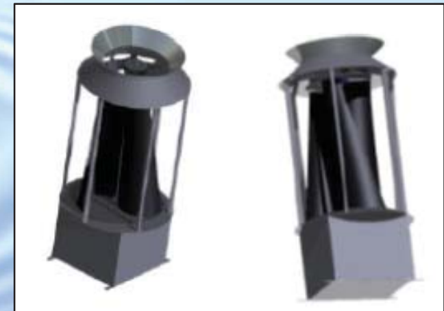
Prototipo turbina eólica en CAD
