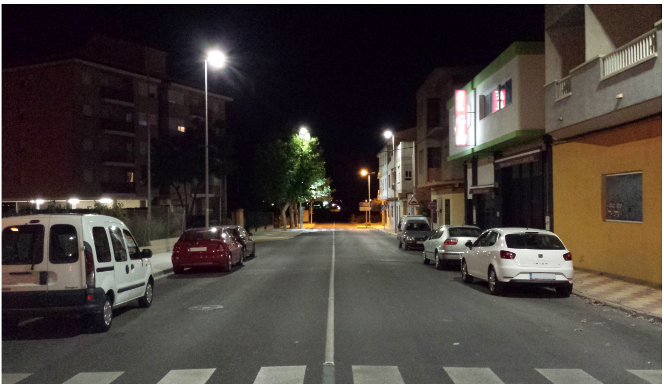
Comparativa alumbrado ya sustituido (LED, luz de alta calidad) y alumbrado anterior (VSBP, situado en la parte final de la calle de la imagen, luz "anaranjada" de baja calidad)
