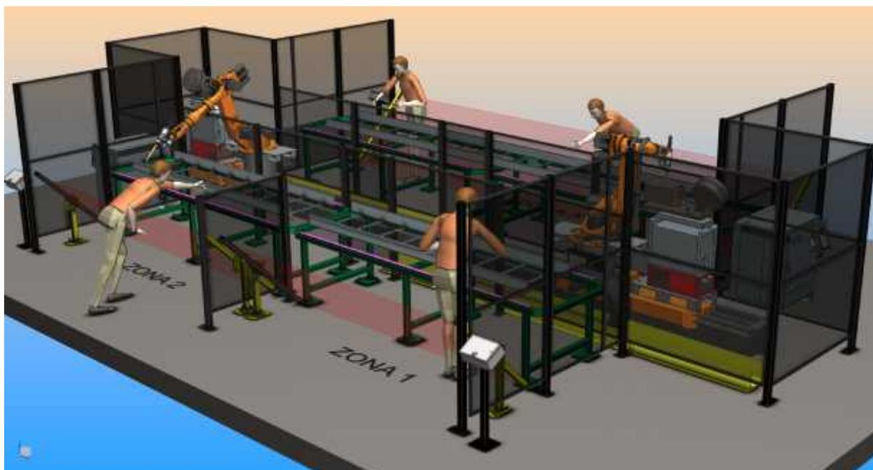
El hecho que los dos robots estén embarcados en una unidad lineal (Track), es lo que confiere a la celda la versatilidad necesaria para puedan desplazarse a lo largo de toda la celda, y por lo tanto que sean los dos robots los que realicen conjuntamente la soldadura, con lo que el tiempo de ciclo se reduce considerablemente.
