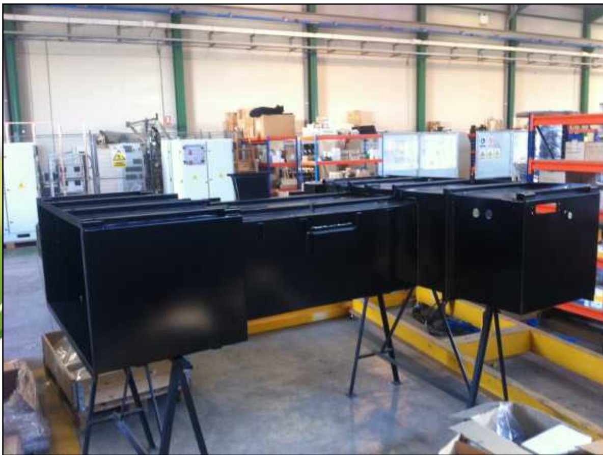
Foto ejemplo estructura Caja de Baterías
